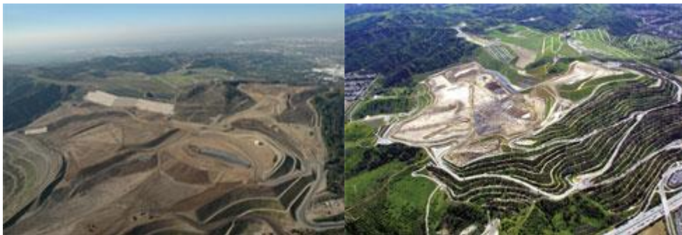
Slika 89. Fotografije jedne od pet velikih deponija grada Los Angelesa – Puente Hills. (završna faza deponije) Fotografija levo nastala je decembra 2005. godine, a na fotografiji desno može se videti kako deponija postaje zeleno brdo, obraslo travom, sitnim rastinjem i žbunastim biljem, pod kojim leže milioni tona otpada.
